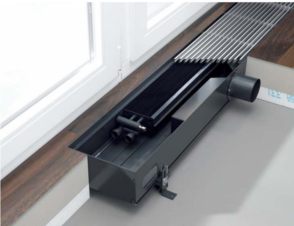
Ascotherm Unterflurkonvektoren KRN 12 sind zur Raumseite mit einem Luftkanal über die gesamte Bodenwannenlänge versehen. Hinzu kommt ein integrierter Zuluftstutzen mit Schieber zur Regulierung des Luftvolumenstroms. Über die gesamte Luftkanallänge angebrachte Schlitze sorgen dabei für eine gleichmäßige Verteilung der Zuluft. Sonstige Ausführung und Lieferumfang wie KRN 11.
