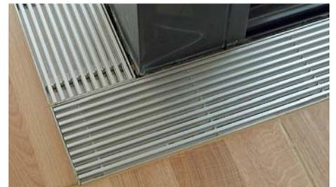
Ascotherm Unterflurkonvektoren KRN 11, ausgelegt für natürliche Konvektion, überzeugen mit hohen Wärmeleistungen durch optimierte Heizregister-Anordnung. Die einbaufertigen Aluminium-Bodenwannen (Extrudal-043) sind mit außen liegenden, verstellbaren Höhenjustierungen versehen. Gummiprofile sorgen dabei für effiziente Trittschallhemmung. Das Wärmeregister, hochwertig gefertigt aus Kupfer-Rohren und Aluminium-Lamellen, ist in Aluminium-Konsolen schallhemmend gelagert.
